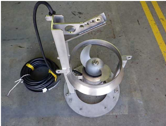
(攪拌装置上部)
