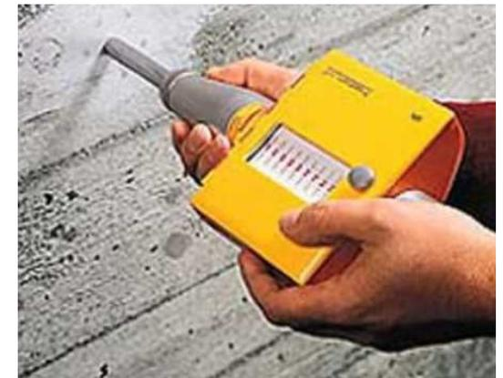
コンクリート面に衝撃を与え、返ってきた衝撃の程度によりコンクリートの強度を推定する方法
