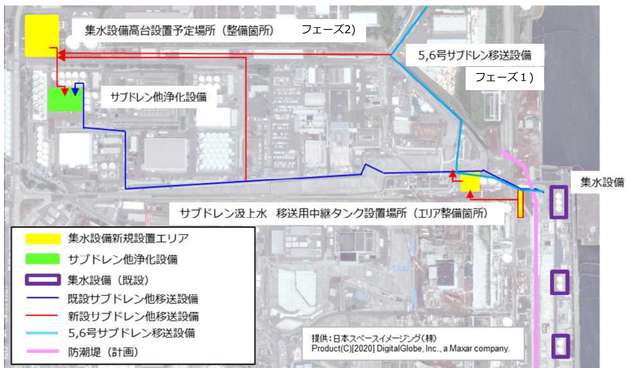
※ サブドレン移送配管計画図 (案)
