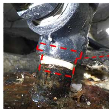
【凍結管継手部 損傷箇所破断状況】
