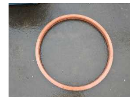
当該漏えい箇所のゴムリング
