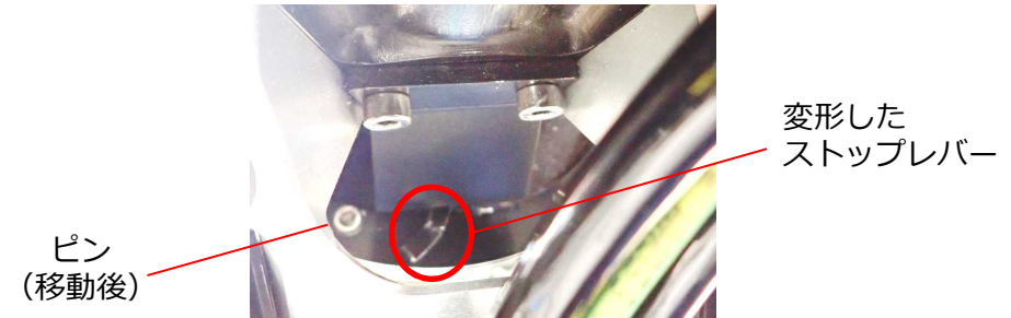
(写真) ピンの移動により、ストップレバーが変形した状態
