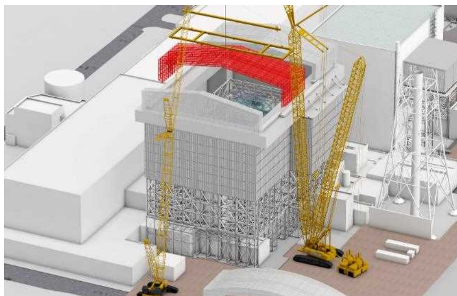
可動屋根設置中
