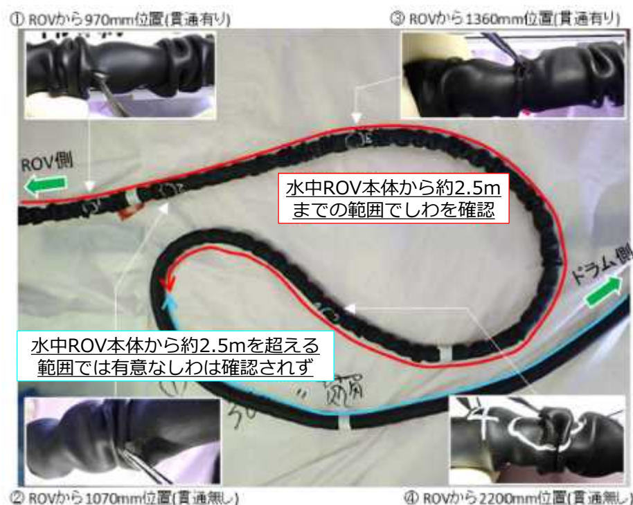
写真1.ケーブル被覆のしわの状況
