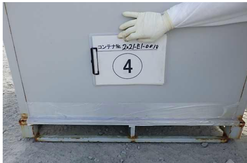
補修済みコンテナ (内容物：β汚染有または0.1mSv/h以上のガレキ)
