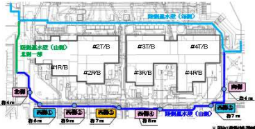
陸側遮水壁（山側）の閉合箇所
