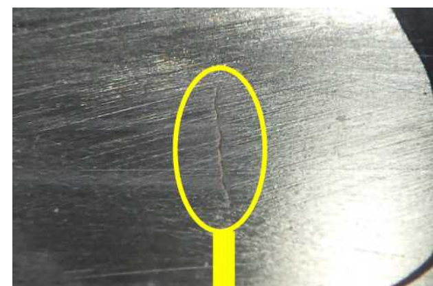
傷の代表例 (傷の長さ2.0 mm (研磨後))
