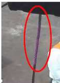
角度変更用ウインチワイヤーの巻き下げ 限界位置マーキングのイメージ
