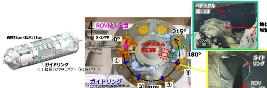
1号機 PCV内部調査実績
