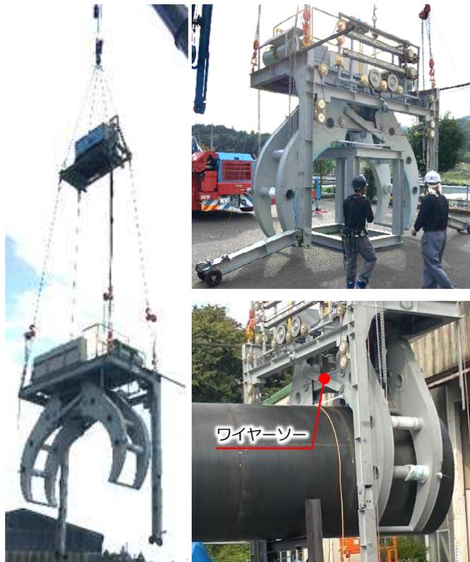
写真④：主排気ダクト切断装置
