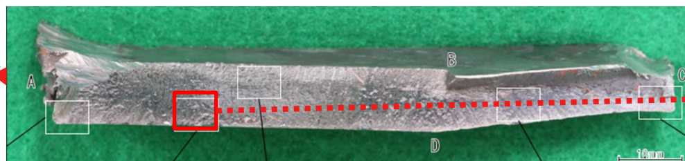
塞ぎプレート破面（上側）
