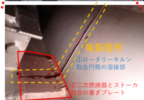
亀裂確認箇所(南側)現場写真
