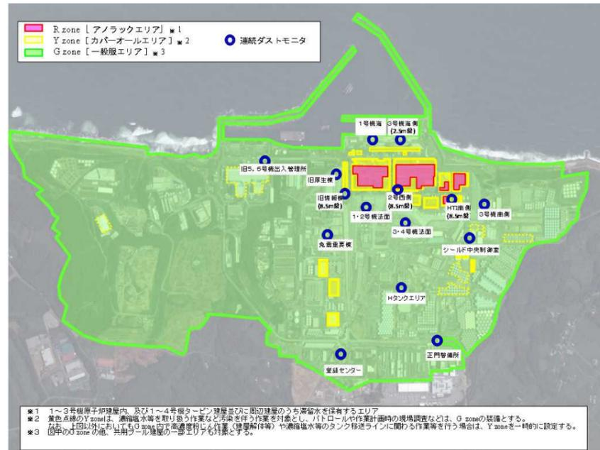
※1 1～3号機原子炉建屋内、及び1～4号機タービン建屋並びに副建屋のうち凝縮水を保管するエリア
