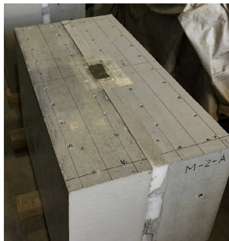
手順 5 : 止水材 (モルタル) 注入完了
