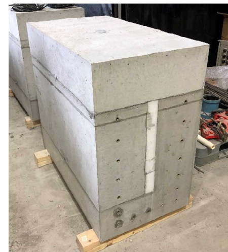
手順 6 : 上部設置 (試験体完成)
