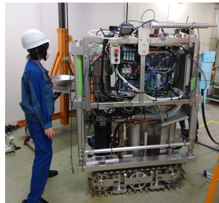
製作中の集積作業用ROV
