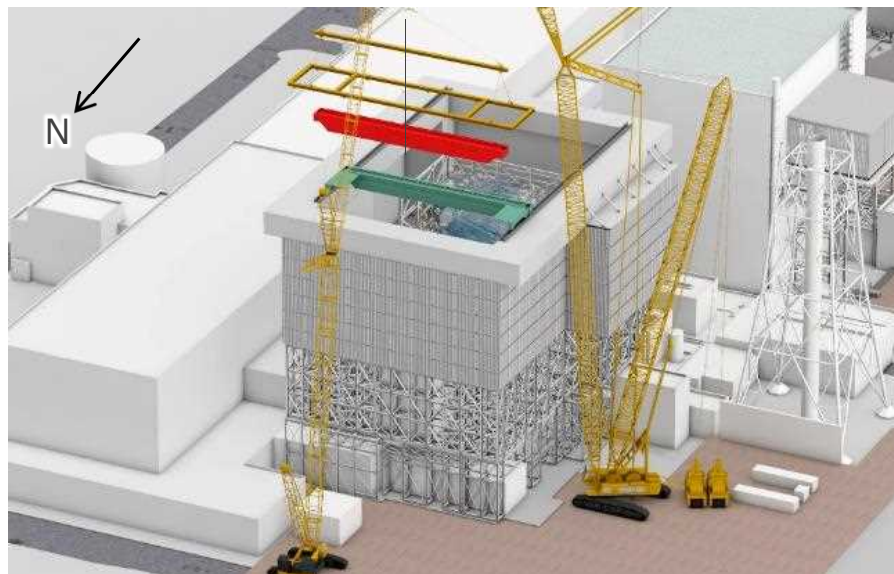
ガレキ撤去用天井クレーン設置中
