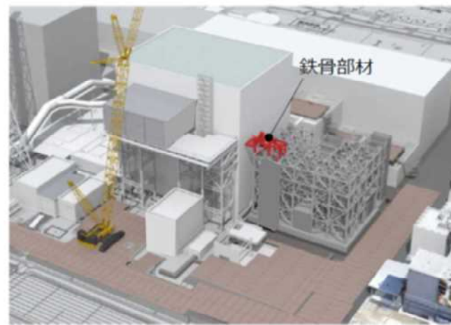
⑤構台鉄骨建方(3層目開始)
