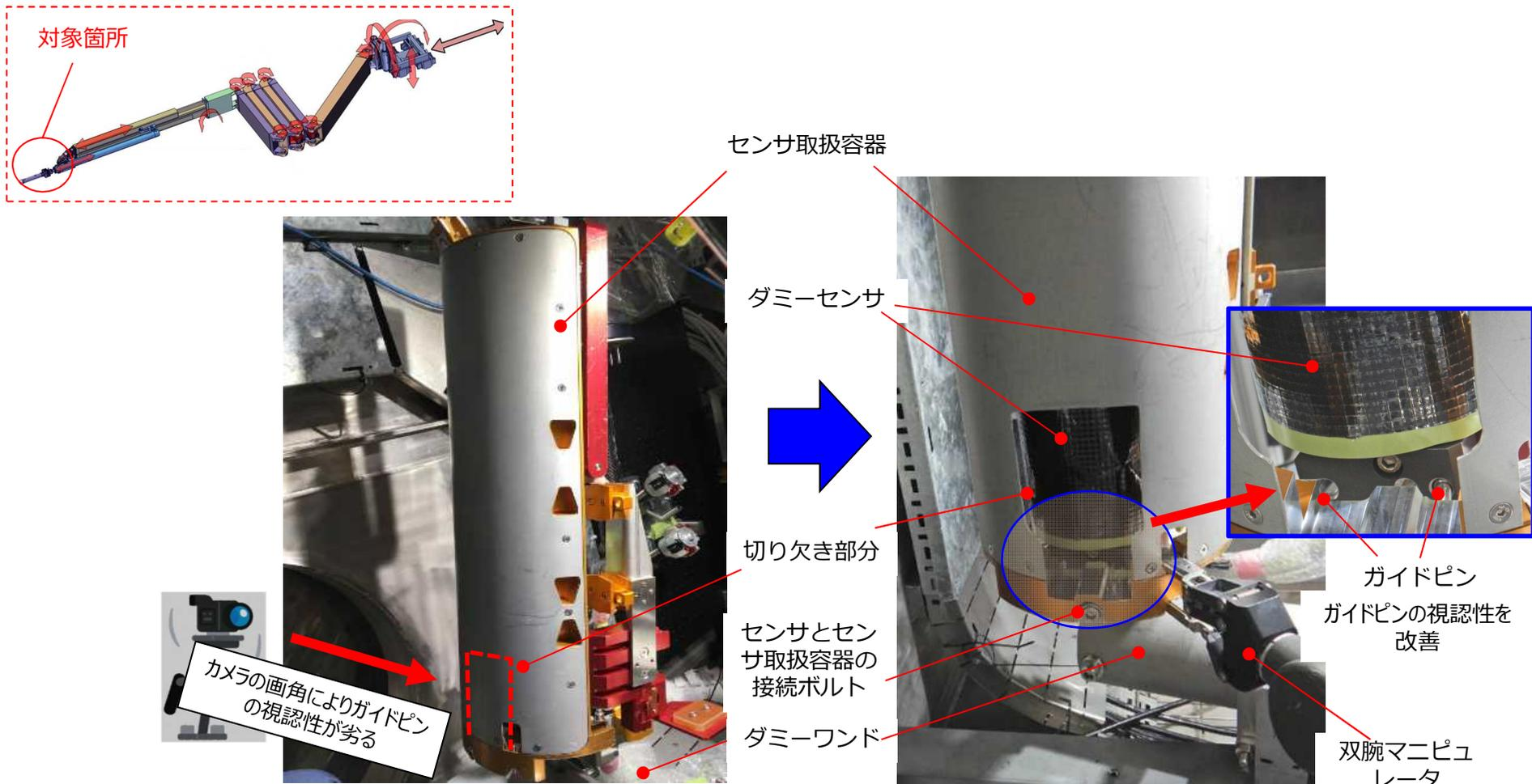
センサ・ツールとアームの接続試験の状況
