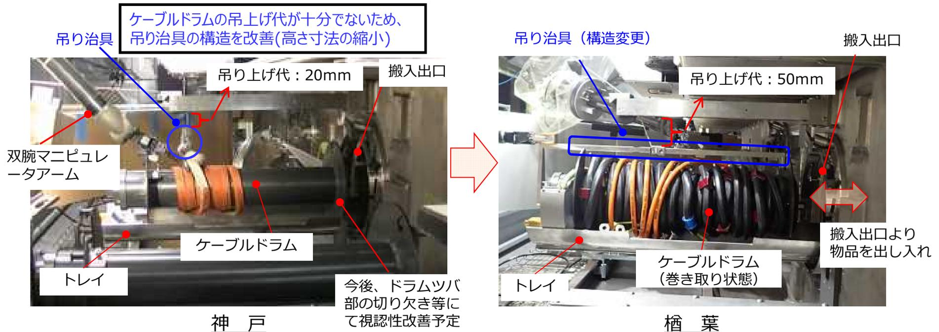
センサ・ツールの搬入出試験の状況 (ケーブルドラム)
