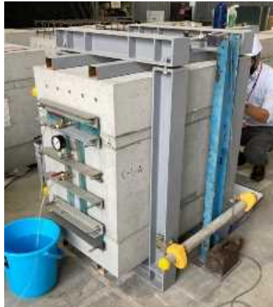
写真1 加圧試験状況
