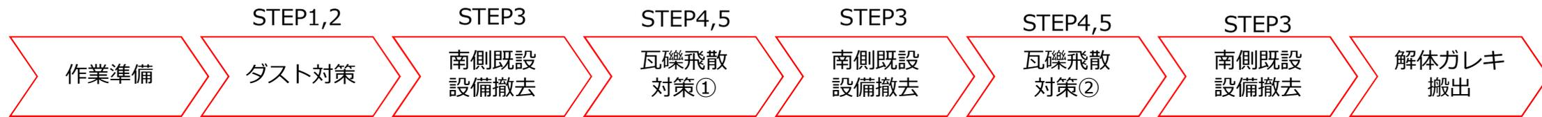
**STEP1** [有人作業] 原子炉建屋屋上に養生カーテン用ウインチ及びスプリンクラーを設置し、スプリンクラーを天井に吊り下げる
