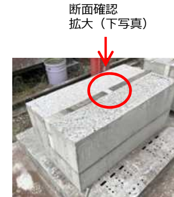
試験体切断位置と切断断面 （試験体を切断し、止水材の断面を確認）
