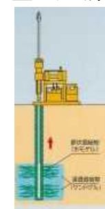
地盤注入（薬液等）
