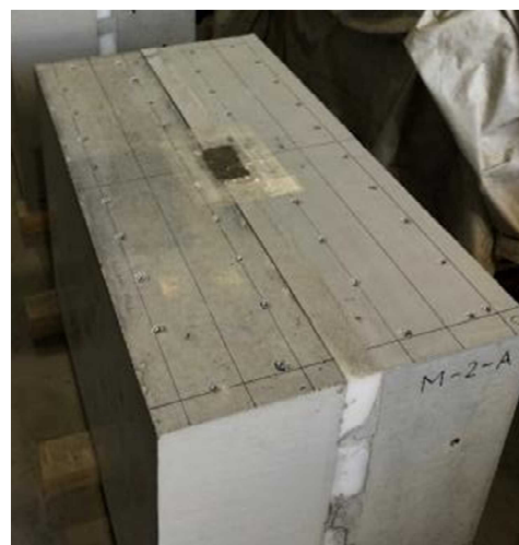
手順 5 : 止水材（モルタル）注入完了
