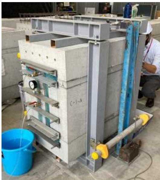
写真1. 試験体（加圧側）
