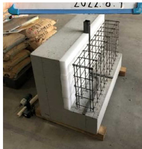
手順 2 : 発泡ポリエチレン、側壁鉄筋組立
