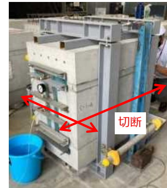
試験体切断位置と切断断面 （試験体を切断し、止水材の断面を確認）
