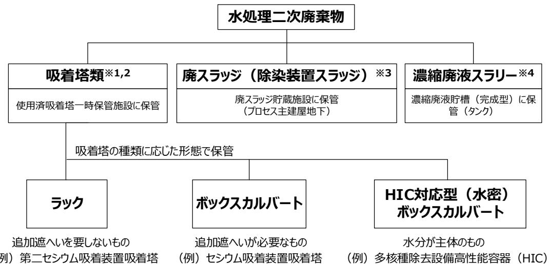
※1建屋滞留水等の汚染水処理に伴って発生する廃棄物。吸着材のほか、スラリー、モバイル式処理装置のフィルタ類などが含まれる。
