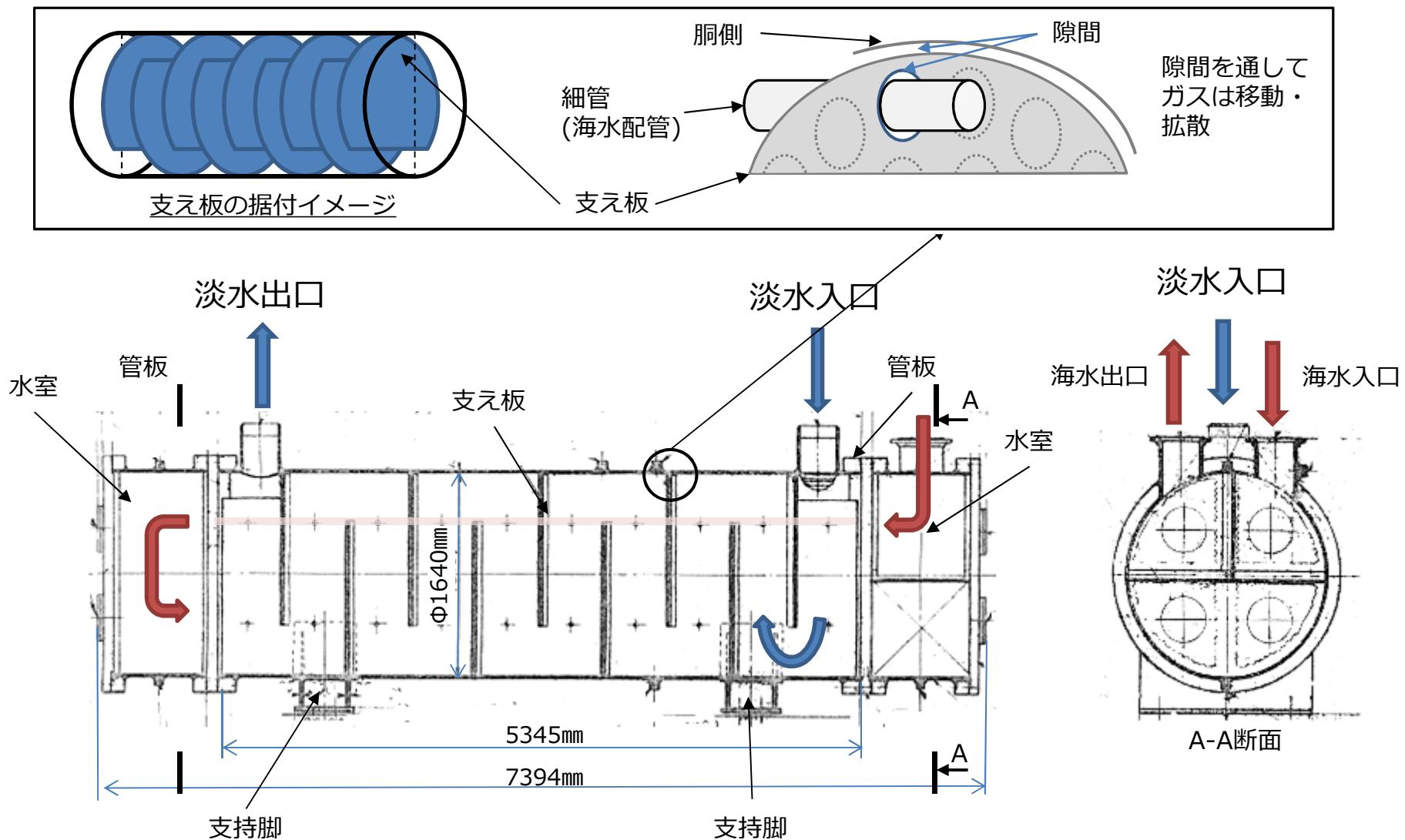
内部に海水配管(細管)があり、その周囲をRCW系統水(内包水:淡水)が流れる。
