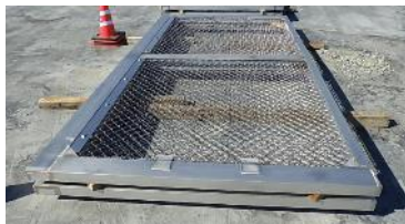
本設魚類移動防止網 (網目 約5cm)
