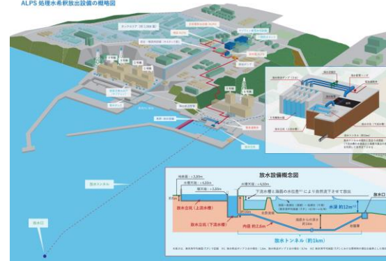
ALPS処理水希釈放出設備の概略図
