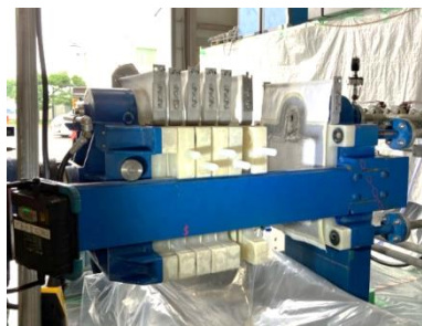
脱水処理(脱水物取出し工程)
