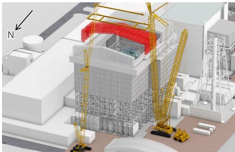
可動屋根設置中
