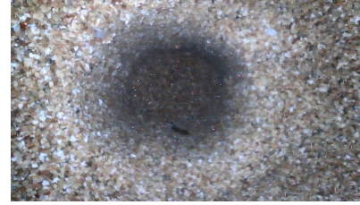
内視鏡映像確認 (試料表面SH貫入部)
