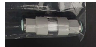
中空系フィルタ (使用後の表面線量率はBG同等)
