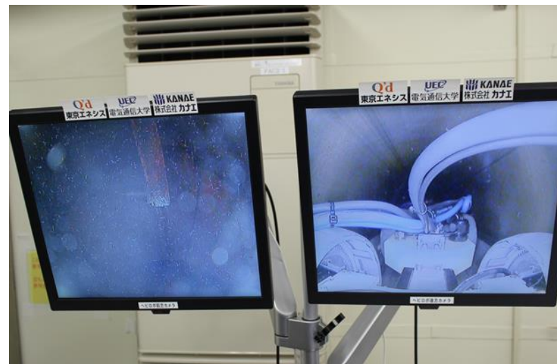
写真2.ヘビ型ロボットインストール状況 (左画面：前方カメラ 右画面：後方カメラ)
