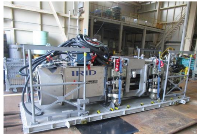
堆積物除去装置（高圧水・AWJ）外観
