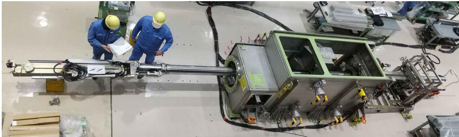
テレスコ式試験的取り出し装置 (装置を上方から撮影)
