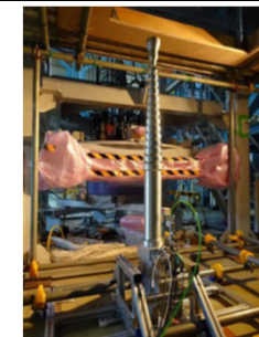
図3 テレスコピック式調査装置(試作機)
