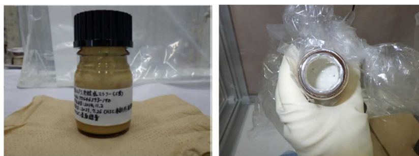
図 分析試料外観 (既設 ALPS スラリー(炭酸塩スラリー)採取試料)
