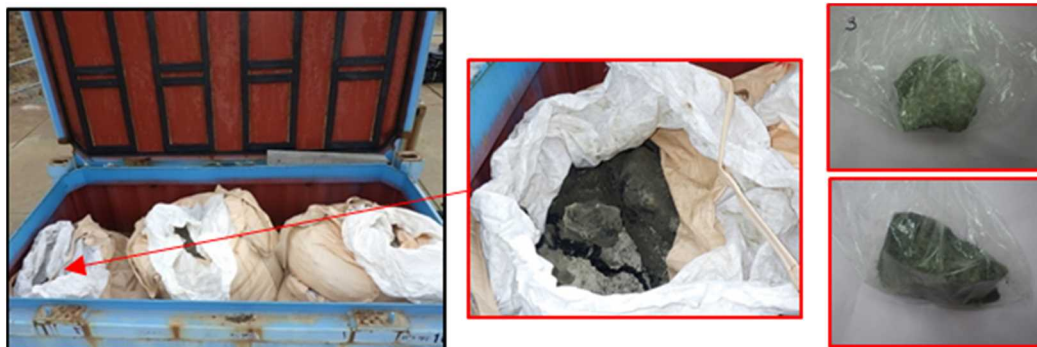
図 分析試料外観 (コンテナ詰替え作業時に採取した瓦礫コンクリート試料)
