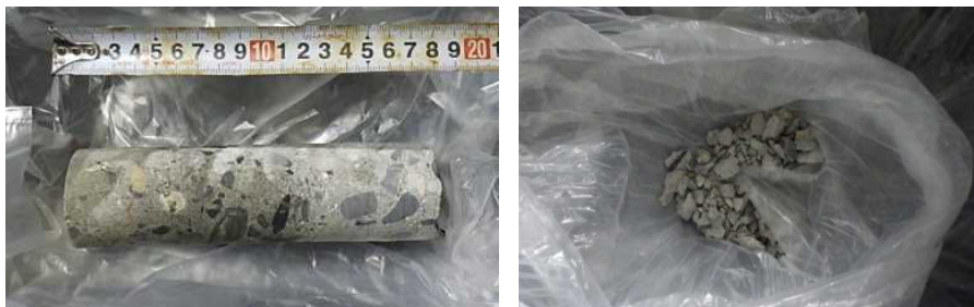
3・4号機廃棄物処理建屋から採取したコア・はつり試料
