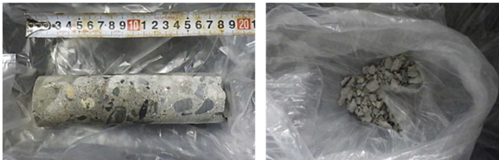
図 分析試料外観 (3・4号機廃棄物処理建屋から採取したコア・はつり試料)
