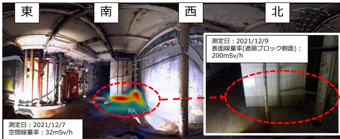
1号機R/B 3階 測定箇所③における \gamma イメージャ測定結果
