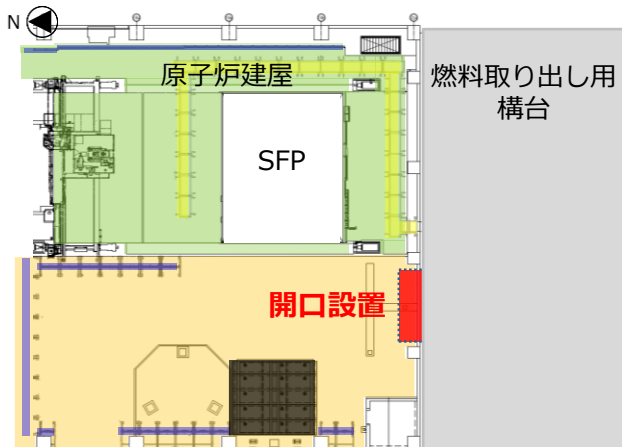
ステップ①開口設置
