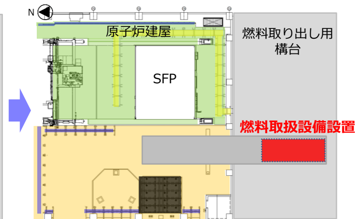
ステップ③燃料取扱設備設置
