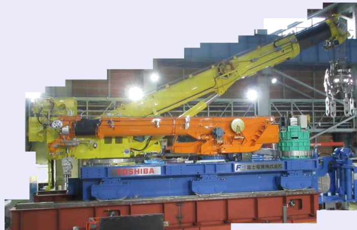
＜燃料取扱設備＞
