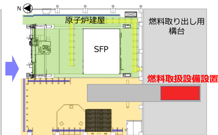
ステップ③燃料取扱設備設置
