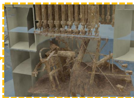
映像・点群データから3Dモデルの作成 (調査データ不足分は震災前の設計図面 + 事故分析の推定から作成)
