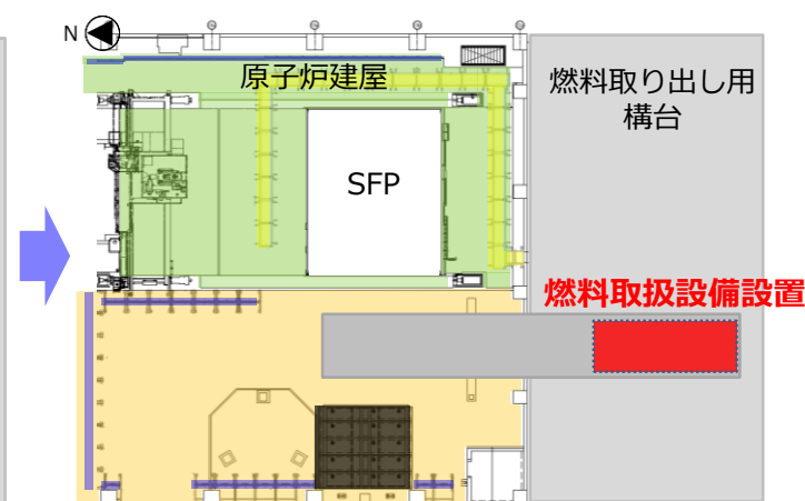
ステップ③燃料取扱設備設置
