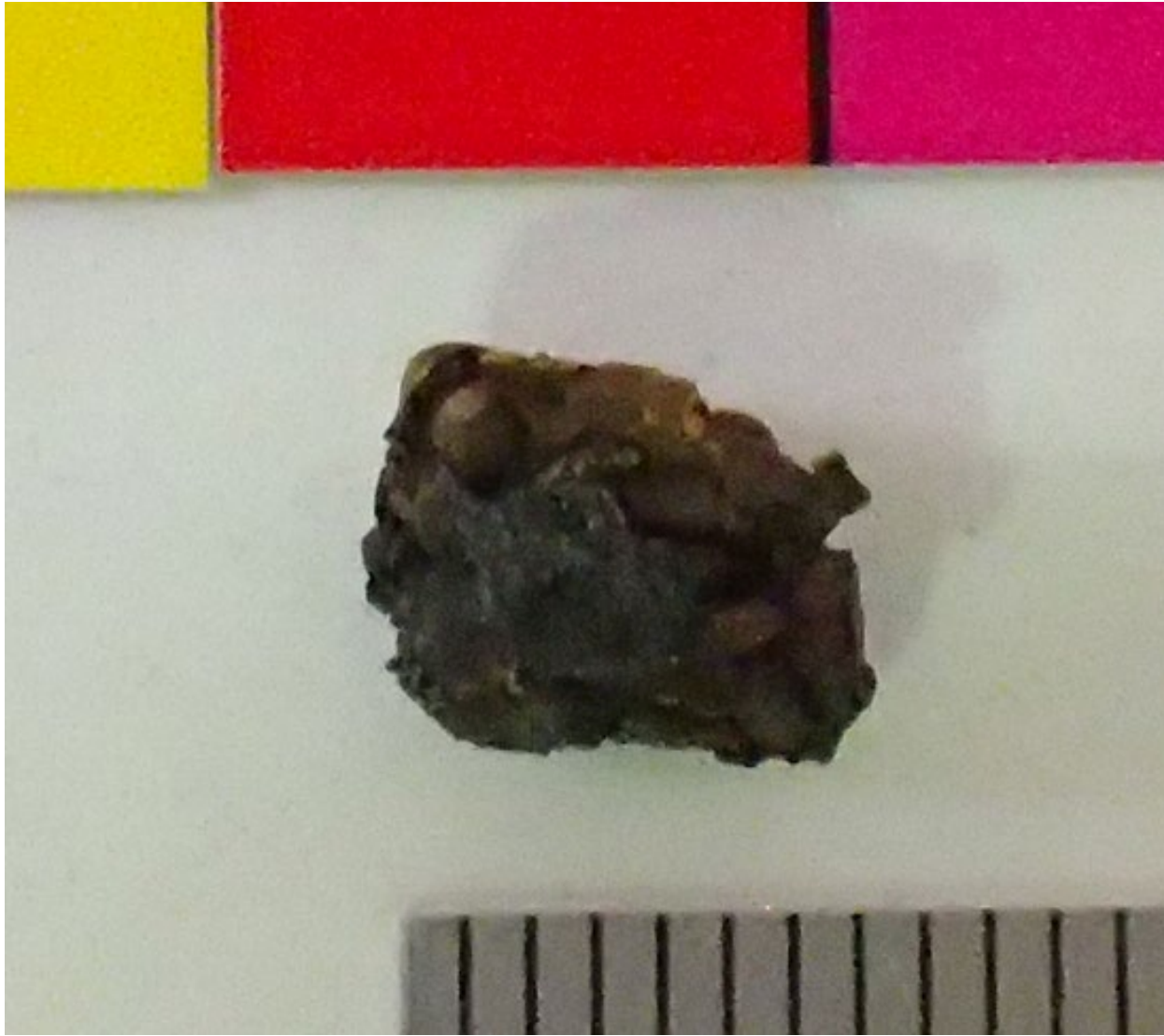
燃料デブリサンプルの外観（色見本、スケールとの比較） 赤褐色に一部黒色のサンプル
