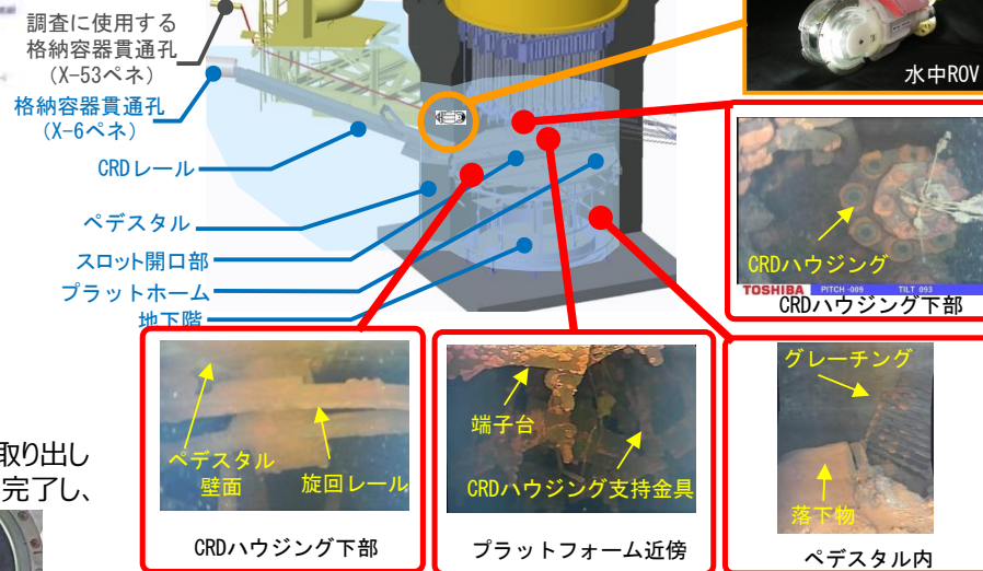
<ペDESTAL内部の状況>
