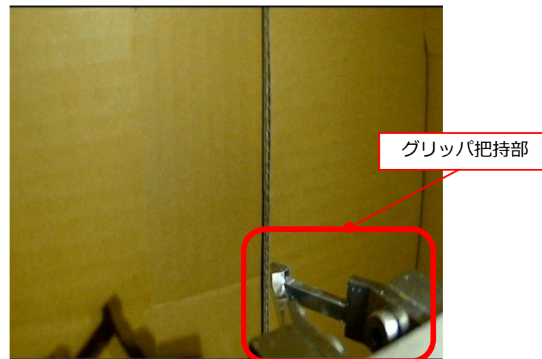
改良後の検証時のカメラ映像 ※暗闇で先端治具照明模擬を点灯した状態
