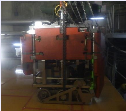
<HTI 1階の集積作業用ROV>（3月5日撮影）
