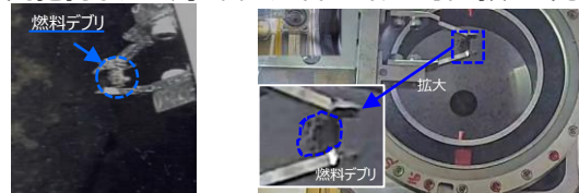
燃料デブリを先端治具で把持した状況
