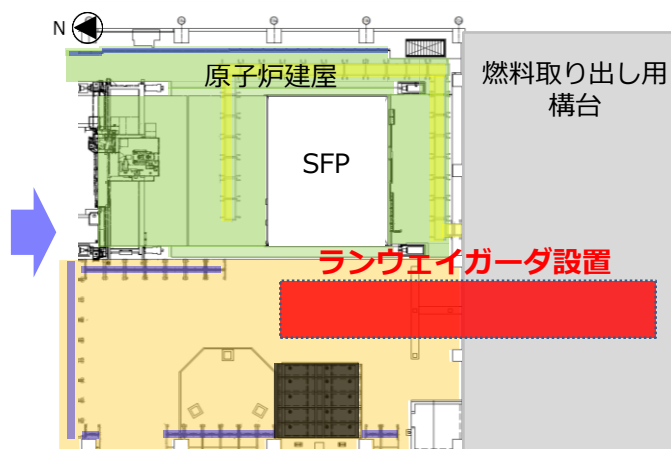
ステップ②ランウェイガーダ設置 完了
