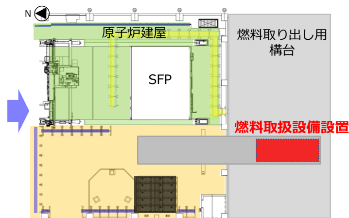
ステップ③燃料取扱設備設置
