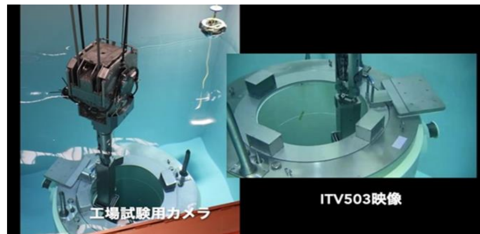
水中動作試験状況（燃料模擬体）
