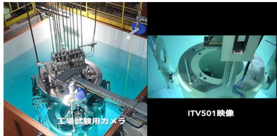
水中動作試験状況（輸送容器模擬体）
