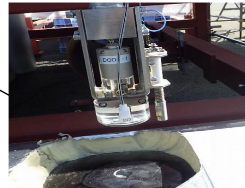
配管穿孔装置のプローブ部 (写真はRCW-Hx入口ヘッダ配管時 のモックアップの状況)
