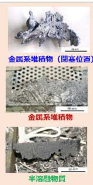
▲燃料デブリ生成メカニズムの検証
