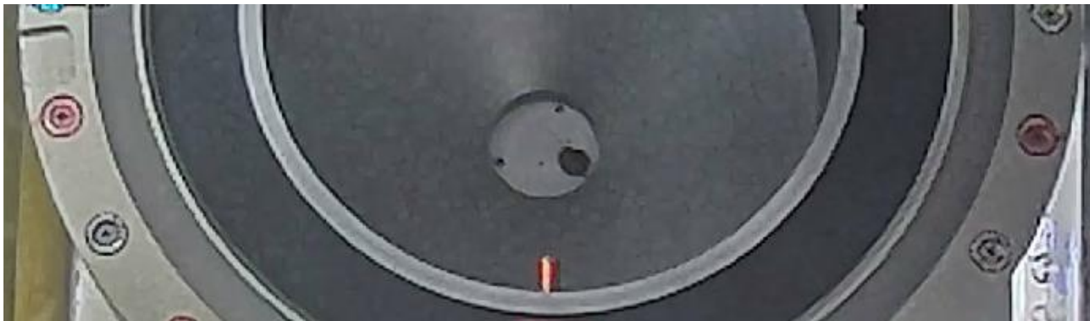
採取した燃料デブリを運搬用ボックス（底部）へ収納した状況（4月22日）
