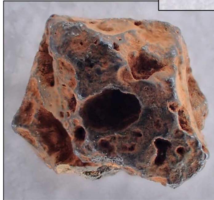
燃料デブリサンプルの外観・拡大写真 (真上から撮影)
